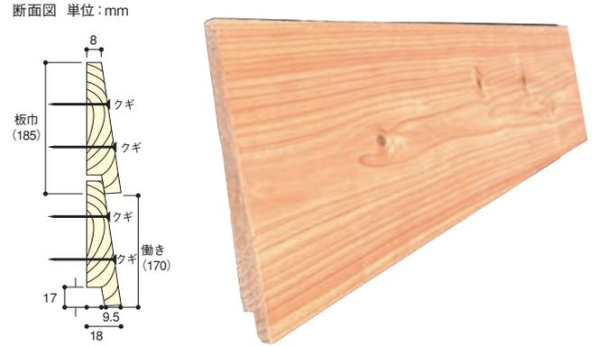
※ジョイントウォールは働き巾の170ピッチで割付けの上、施工をお願いします。押え縁使用時は押え縁に合わせて割付けしてください。
