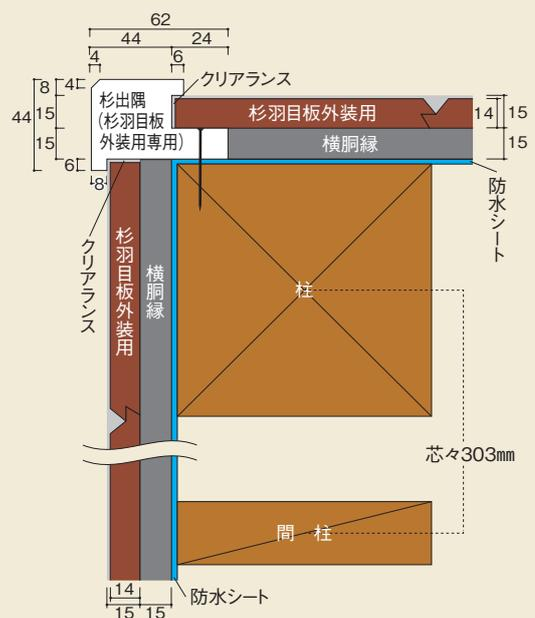
※杉羽目板外装用施工時には必ず水切りを使用してください。
