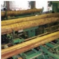
収穫した木材は、木の特質ごとに柱、板材などに製材されます。厳しい品質管理により、一定の品質を確保することで、価格の安定につなげます。
