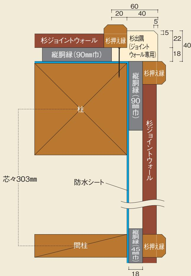
※杉・外壁・ジョイントウォール施工時には必ず水切りを使用してください。
